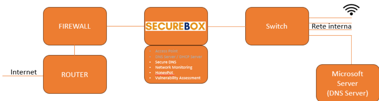
Abbildung 3: Für dieses Szenario wird der Netzwerkaufbau um einen internen Microsoft-Server ergänzt, der die DNS- und DHCP-Funktionen übernimmt.
